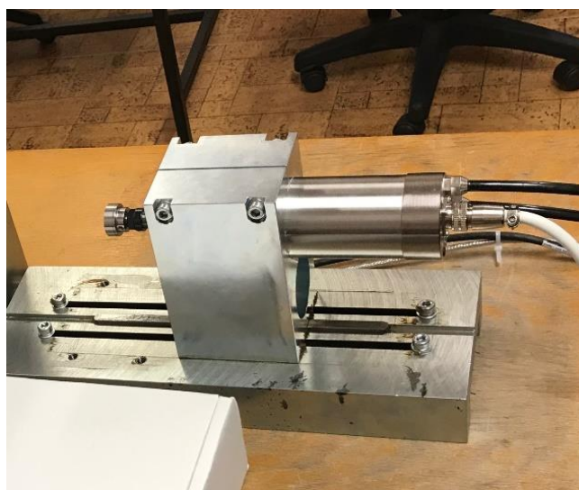
Obr. 44 Elektromotor s chlazeným pláštěm.
