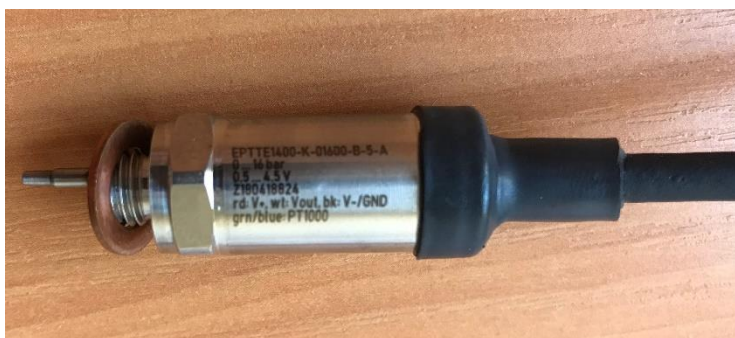
Obr. 34 Kombinovaný snímač teploty a tlaku VARIOHM EPTTE 1400.
