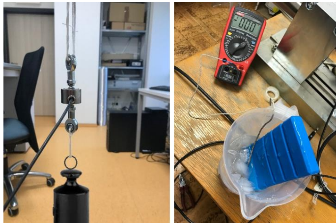
Obr. 54 Ukázka kalibrace snímačů. Vlevo snímač síly, vpravo snímač teploty.
