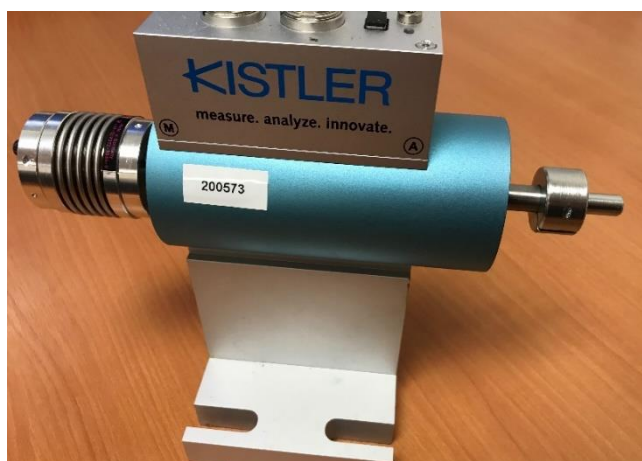
Obr. 32 Kombinovaný snímač točivého momentu a otáček.
