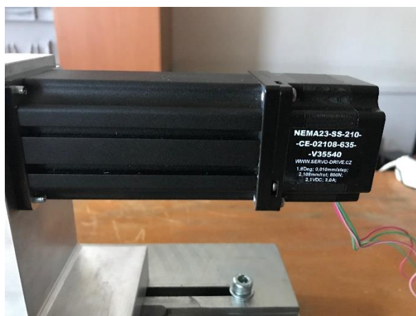
Obr. 36 Sestava krokového motorku a převodníku pohybu.
