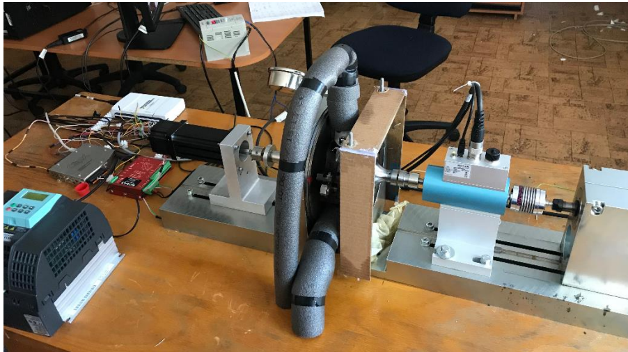
Obr. 57 Ukázka izolace olejového potrubí v místě turbodmychadla.
