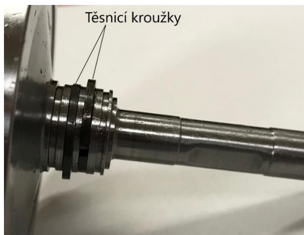
Obr. 28 Těsnicí kroužky rotoru turbodmychadla GT 35.
