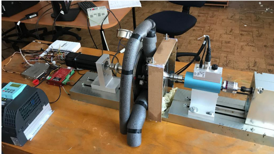
Obr. 57 Ukázka izolace olejového potrubí v místě turbodmychadla.
