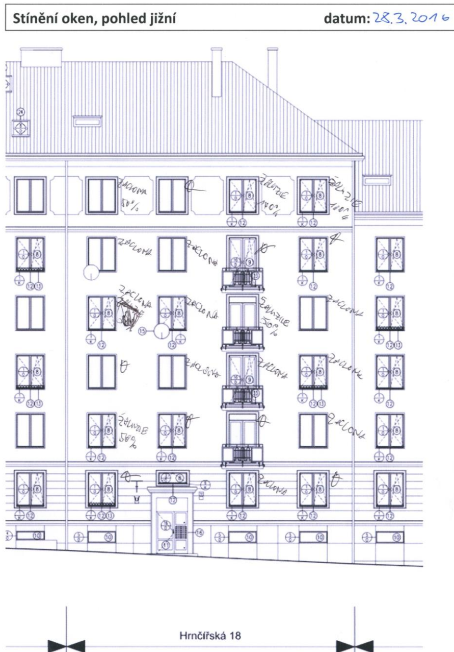
Obrázek 21 Příklad záznamu pro určení součinitele stínění
