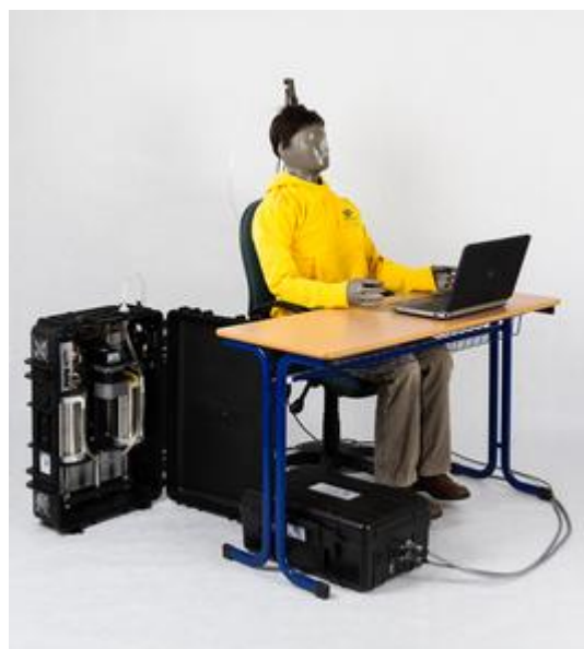
Obr. 14 Tepelný manekýn a rozdelenie jeho povrchu na 34 segmentov [24,25].
