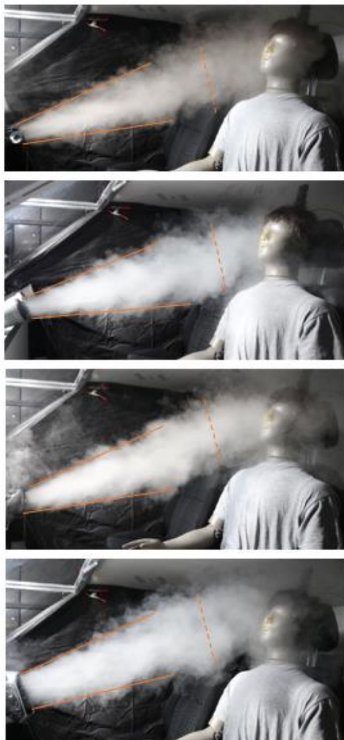
Obr. 61 Vizualizácia prúdových polí vytvorených jednotlivými výstkami pomocou dymovej metódy, pohľad z boku. Výustky postupne zhora: BMW, Dacia, Mercedes, Porsche.
