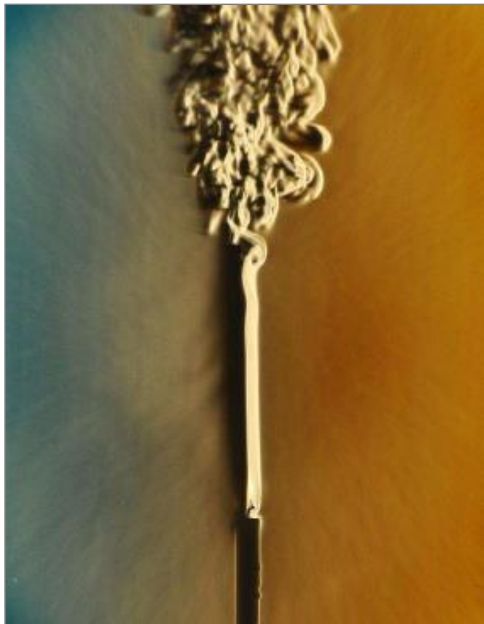
Obr. 10 Stúpajúci dym zo sviečky – prechod laminárneho prúdenia do turbulencie.
