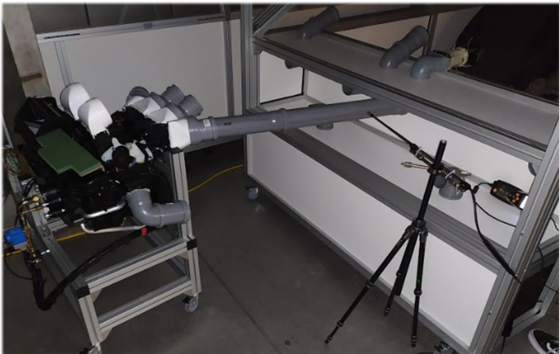
Obr. 28 Zapojenie HVAC jednotky Valeo 2 do meracej trate.
