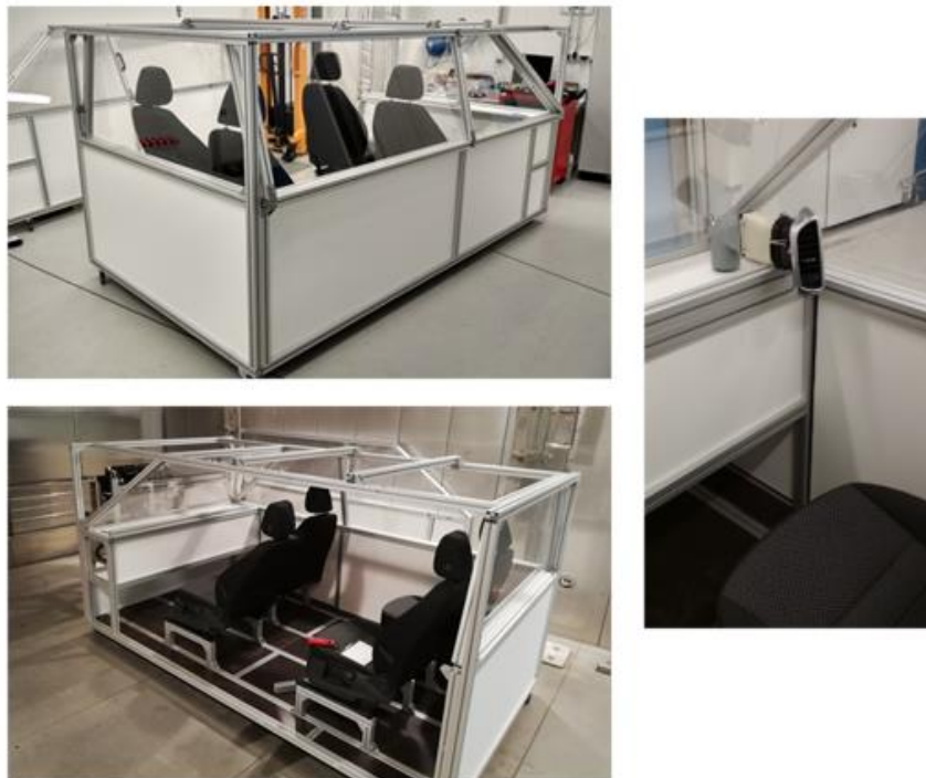
Obr. 19 Maketa kabíny automobilu fotená v dobe príprav (strop, prírodné kanály atď. boli neskôr doplnené a výustka bola umiestnená na stred, vid' fotky rozloženia experimentu ďalej v práci).
