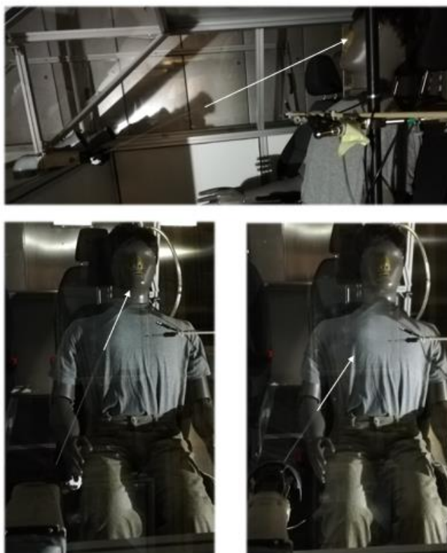
Obr. 31 Vizualizácia smerovania prúdu z výstiek pomocou niťovej sondy (hore, vľavo dole – smerovanie na tvár, vpravo dole – smerovanie na hrud').
