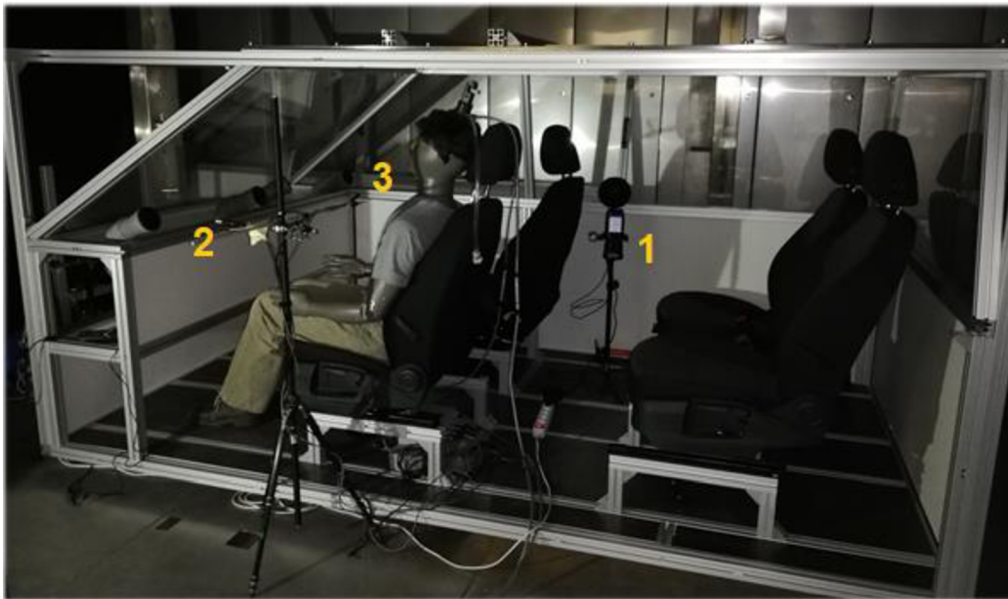
Obr. 26 Rozloženie experimentu: 1- Testo 480, 2- senzor teploty vzduchu, 3- anemometer, senzor vlhkosti a senzor teploty vzduchu.
