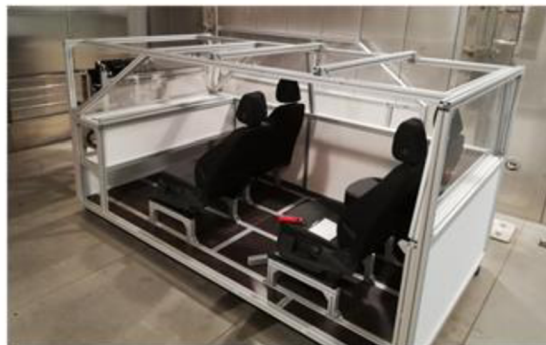
Obr. 19 Maketa kabíny automobilu fotená v dobe príprav (strop, prívodné kanály atď. boli neskôr doplnené a výustka bola umiestnená na stred, vid' fotky rozloženia experimentu ďalej v práci).
