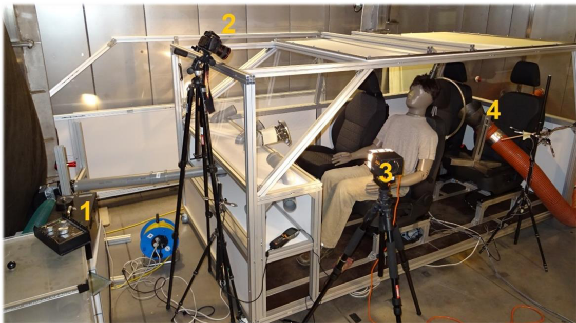
Obr. 59 Rozloženie experimentu: 1 – generátor dymu, 2 – fotoaparát Canon 100, 3 – zdroj svetla, 4 – odsávanie dymu.
