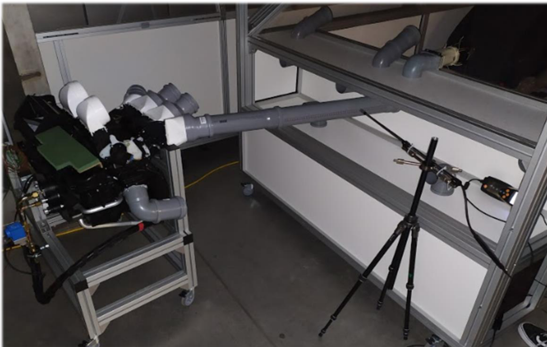
Obr. 28 Zapojenie HVAC jednotky Valeo 2 do meracej trate.
