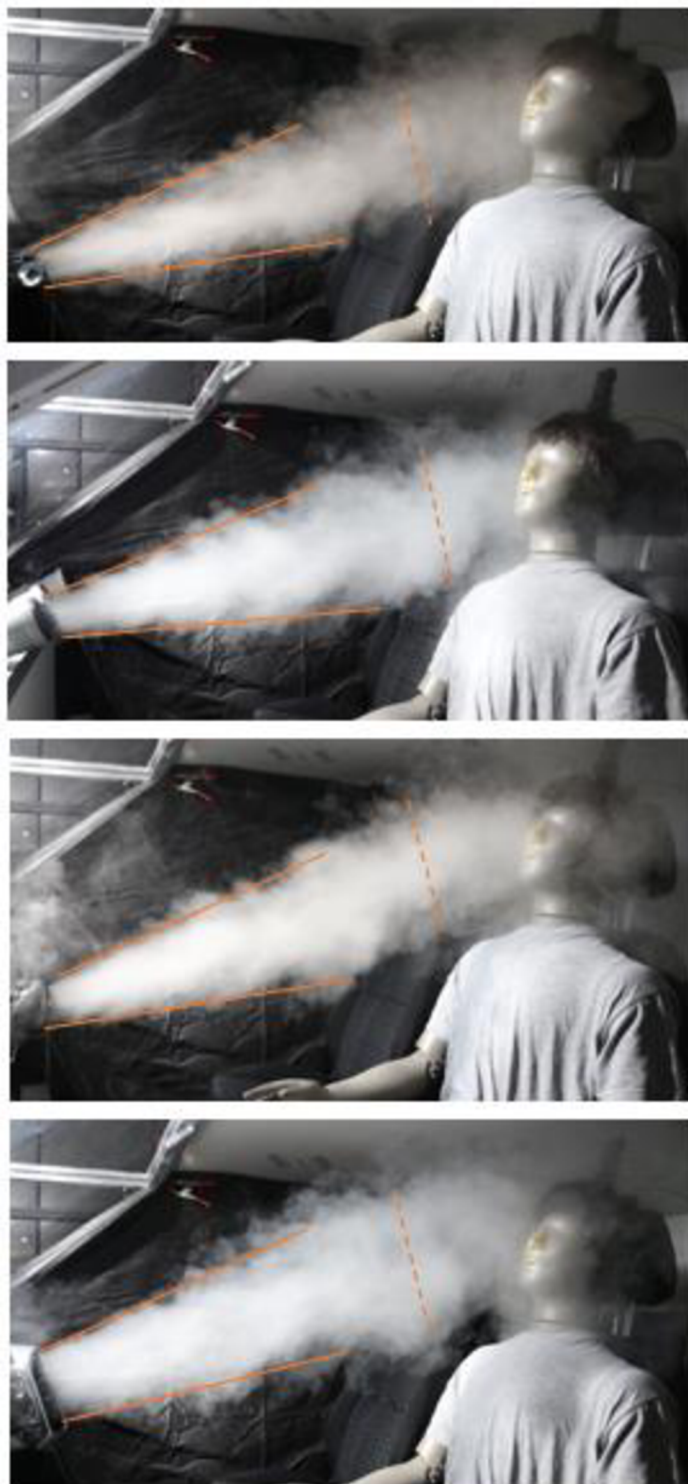
Obr. 61 Vizualizácia prúdových polí vytvorených jednotlivými výstkami pomocou dymovej metódy, pohľad z boku. Výstky postupne zhora: BMW, Dacia, Mercedes, Porsche.
