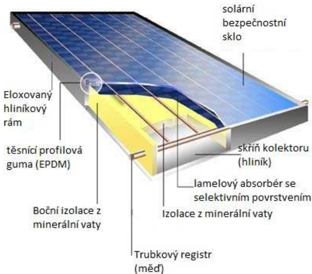
Plochý kolektor se selektivním povrchem
