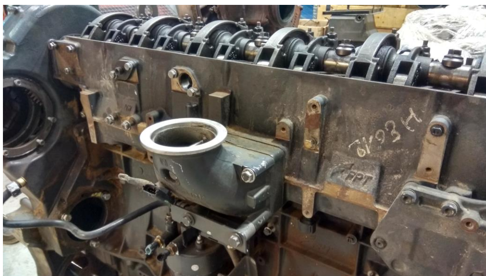
Obr. 29 Vstup do sání. Poslední člen potrubí před sací komorou umístěnou v hlavě válců. Uvnitř tohoto členu je integrován elektrický přídavný ohřívač vzduchu [25]
