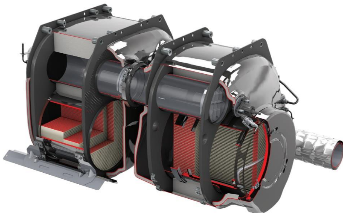
Obr. 25 Řez jednotkou pro snížení emisí motoru DAF PACCAR MX-13 [8]
