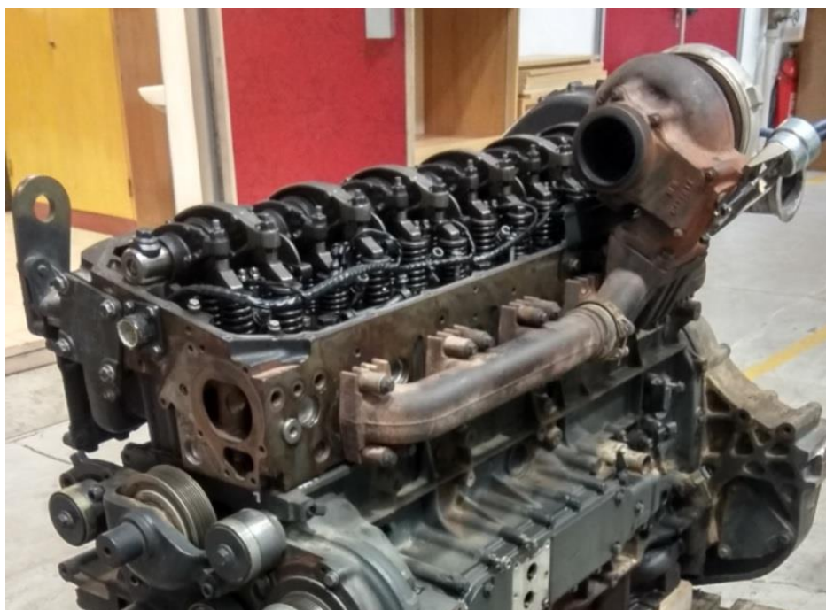
Obr. 30 Trojice spojených výfukových svodů a turbodmychadlo zadaného motoru (druhá trojice je umístěná pod a za turbodmychadlem)[25]
