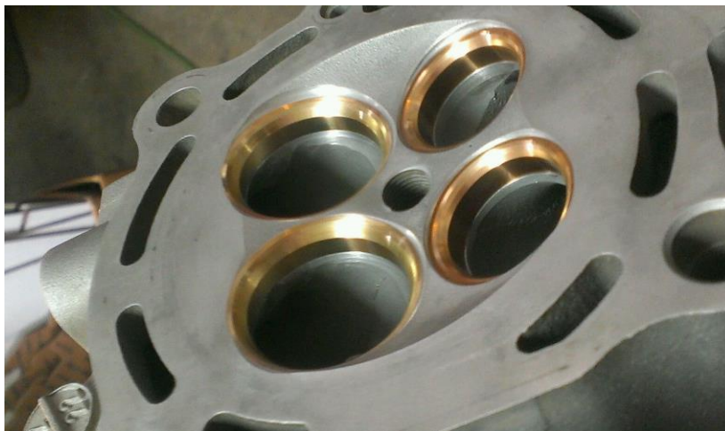
Obr. 7 Vkládaná sedla ventilů [17]
