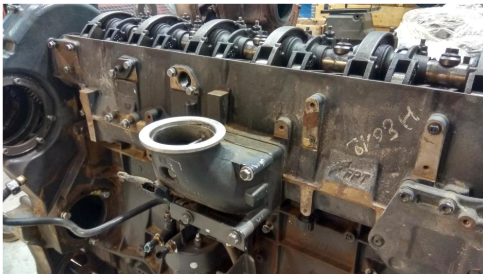
Obr. 29 Vstup do sání. Poslední člen potrubí před sací komorou umístěnou v hlavě válců. Uvnitř tohoto členu je integrován elektrický přídavný ohříváč vzduchu [25]
