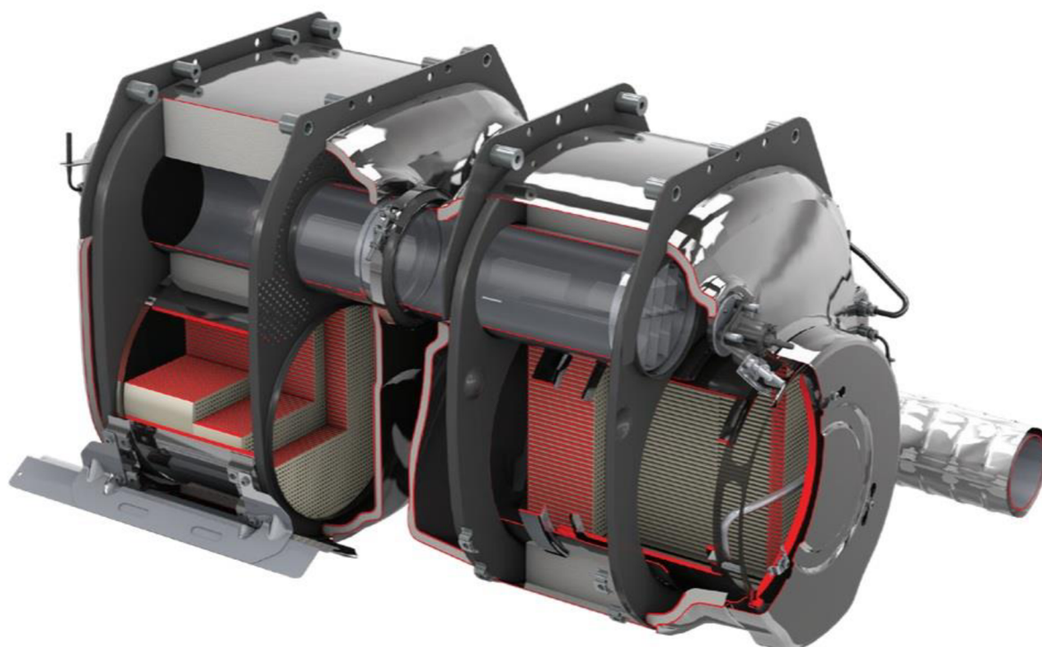
Obr. 25 Řez jednotkou pro snížení emise motoru DAF PACCAR MX-13 [8]
