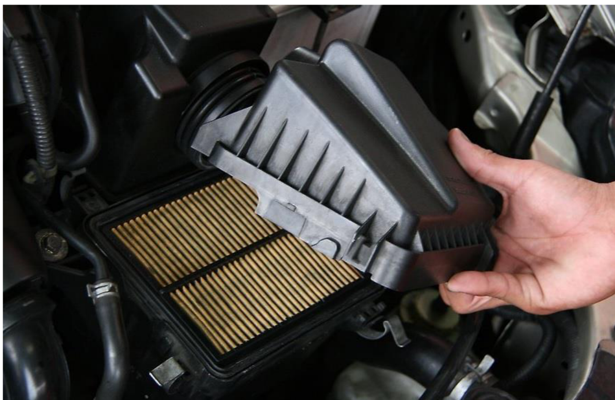
Obr. 2 Otevřený čistič vzduchu se vzduchovým filtrem v osobním automobilu Honda [14]
