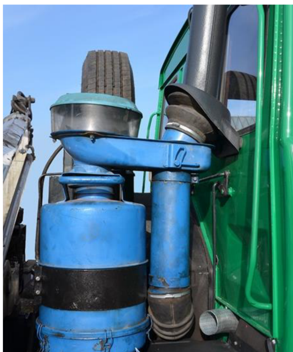
Obr. 16 Kombinace čističe vzduchu s olejovou lázní a odstředivého předřazeného odlučovače hrubého prachu [20]
