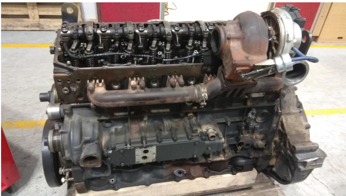
Obr. 27 Motorová jednotka Iveco Cursor C13 F3H [25]
