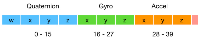
Obrázek 5.6: Struktura FIFO fronty z DMP na MPU6050.
