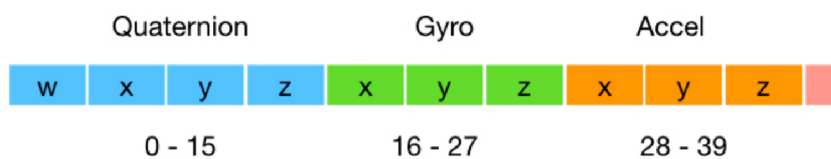
Obrázek 5.6: Struktura FIFO fronty z DMP na MPU6050.
