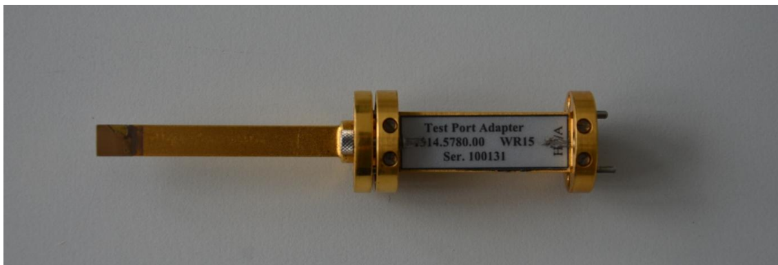
Obrázok 5.1-1 Otvorené ústie vlnovodu WR15 použité ako prijímacia anténa.
