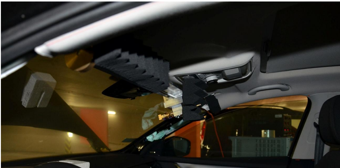
Obrázok 5.0-4 Lišta s bežcom doplnená o absorpčné ihlany a prijímaciu anténu (Rx).
