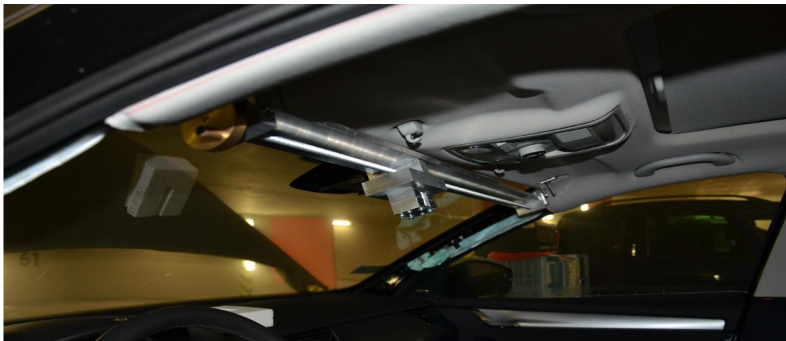
Obrázok 5.0-2 Lišta s bežcom upevnená v prednej časti automobilu.
