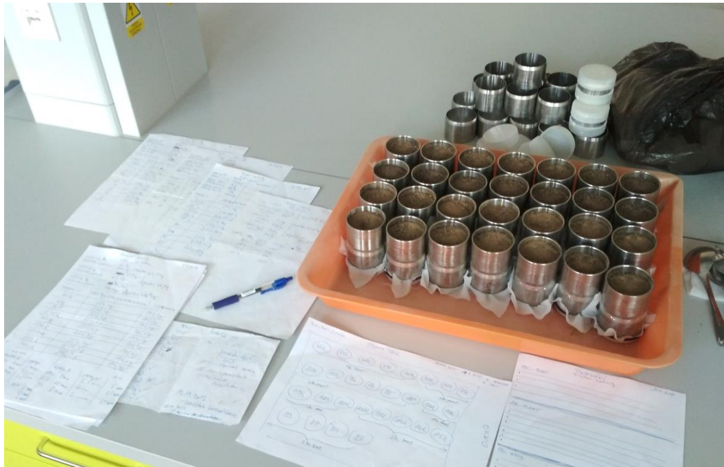
Obrázek 4: Příprava půdních vzorků v Kopeckého válečkách (vlastní zpracování).
