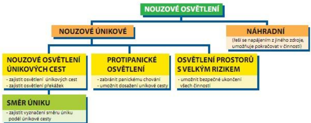
Obr. 5-1 Rozdělení nouzového osvětlení
