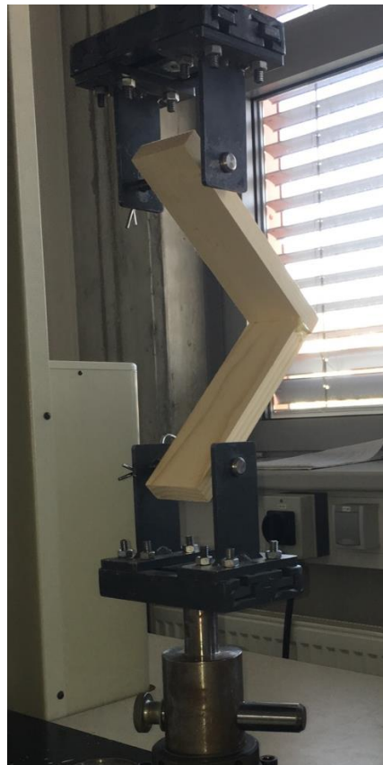
Obrázek 37. Upnutí vzorku do stroje, zdroj: vlastní
