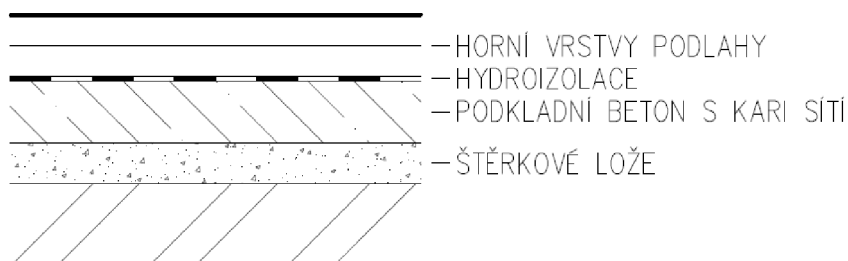
Obr. č. 11. Řez podlahou v přízemí
