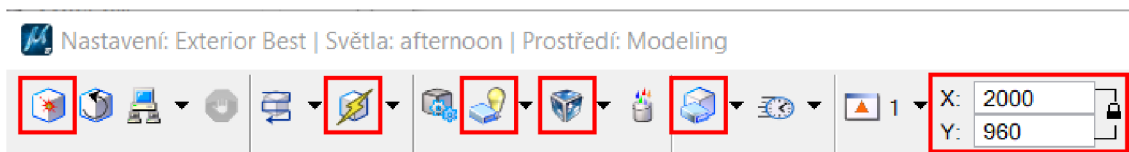
Obr. č. 50: Nastavení a spuštění renderingu (zleva: spuštění, náhled, světla, prostředí, rendering, velikost) [autor]
