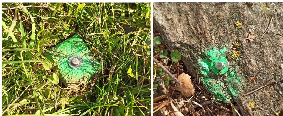
Obr. č. 9 a 10: Stabilizace dřevěným kolíkem v půdě a nástřelným hřebem v kameni [autor]
