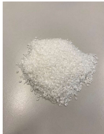
Obr. 10 Frakce plastové drtě 4–6 mm. Zdroj vlastní
