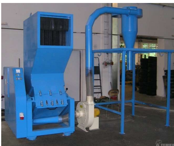
Obr. 5 Nožový mlýn G400/400 s rámem na bigbagy [22]
