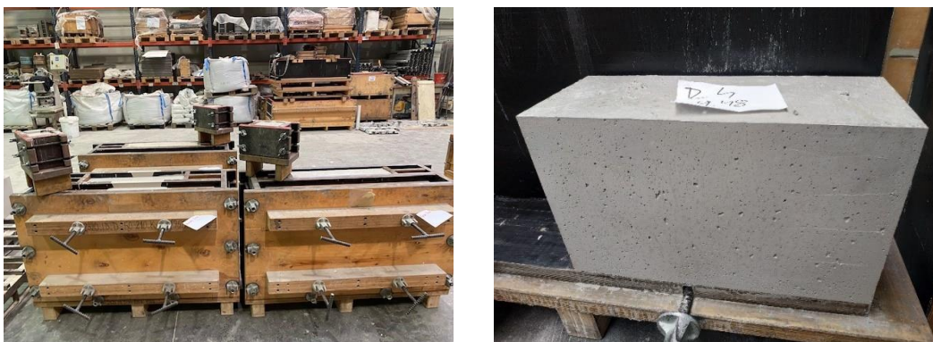
Obr. 59: Připravené žárobetony odlité do formy – vlevo, prefabrikovaný žárobeton po odformování – vpravo
