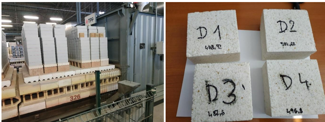
Obr. 66: Lehčené dinasové tvarovky LS8-155
