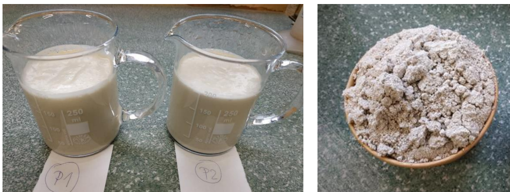
Obr. 60: Napěněné suspenze P1 a P2 (vlevo), P2 po vysušení (vpravo)
