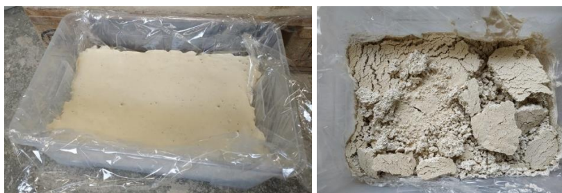
Obr. 62: Napěněná suspenze P2 (vlevo), po vysušení (vpravo)
