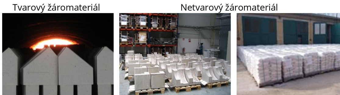
Obr. 2: Tvarový žáromateriál, prefabrikovaný výrobek, suchá směs
