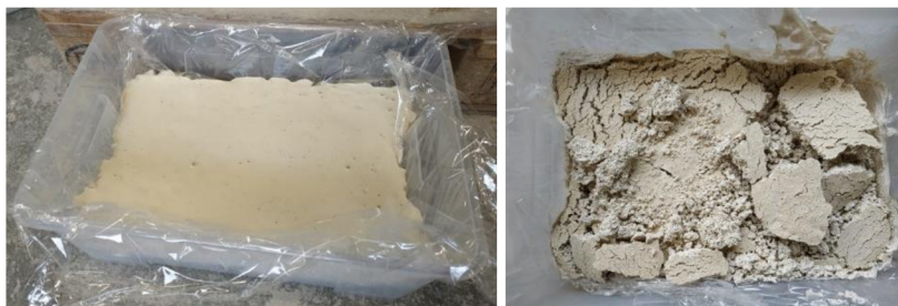
Obr. 62: Napěněná suspenze P2 (vlevo), po vysušení (vpravo)
