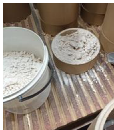
Obr. 65: Dinasové pěněné ostřivo po výpalu se sortimentem komínových vložek V Tab. 32 jsou uvedeny kritéria hutnosti a chemické složení ostřiv DOP1 a DOP2.
