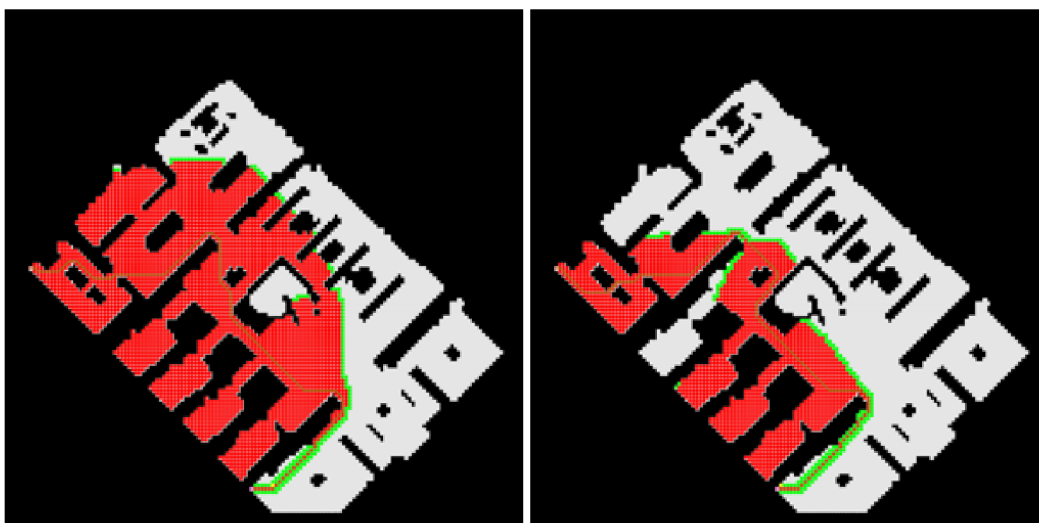
Obr. 13: Velikost prohledaného prostoru algoritmy: A* (vlevo), wA* ( w = 2 , vpravo), převzato z [29]
