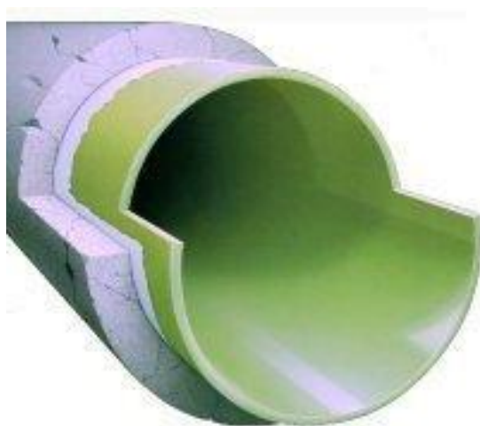
Obr. 6.5 – Řez opravenou stokou pomocí GFK Lineru
