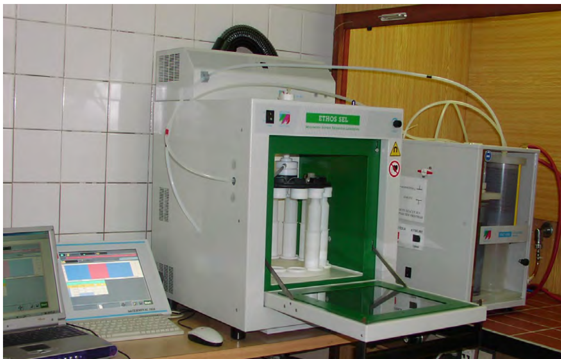
Obr. č. 19: Laboratorní rozkladná mikrovlnná jednotka ETHOS SEL
