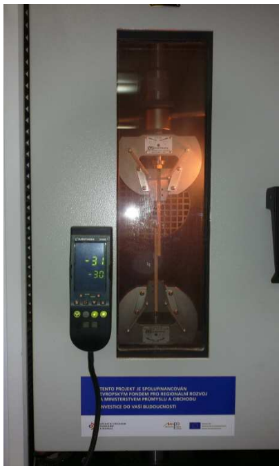
Obr. 17 – Klimatizační komora při teplotě – 30 °C (galerie autora)
