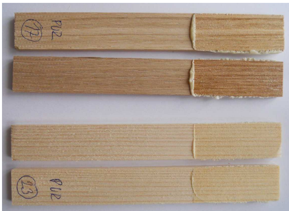
Obr. 24 – Porušení vzorků dubu a smrku, lepených PUR lepidlem a vystaveným smykové zkoušce tahem při teplotě 5 °C (galerie autora)
