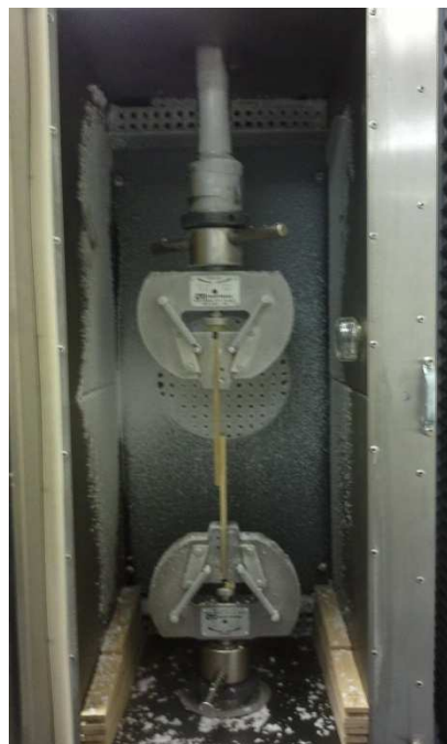
Obr. 18 – Pohled do klimatizační komory při teplotě – 30 °C (galerie autora)
