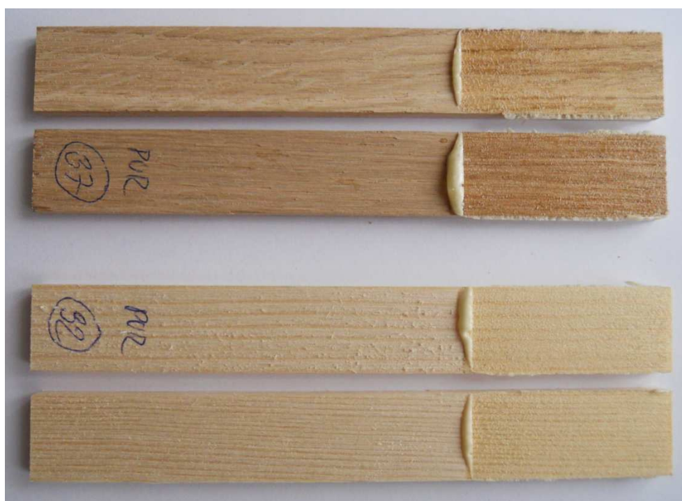
Obr. 26 – Porušení vzorků dubu a smrku, lepených PUR lepidlem a vystaveným smykové zkoušce tahem při teplotě - 30 °C (galerie autora)
