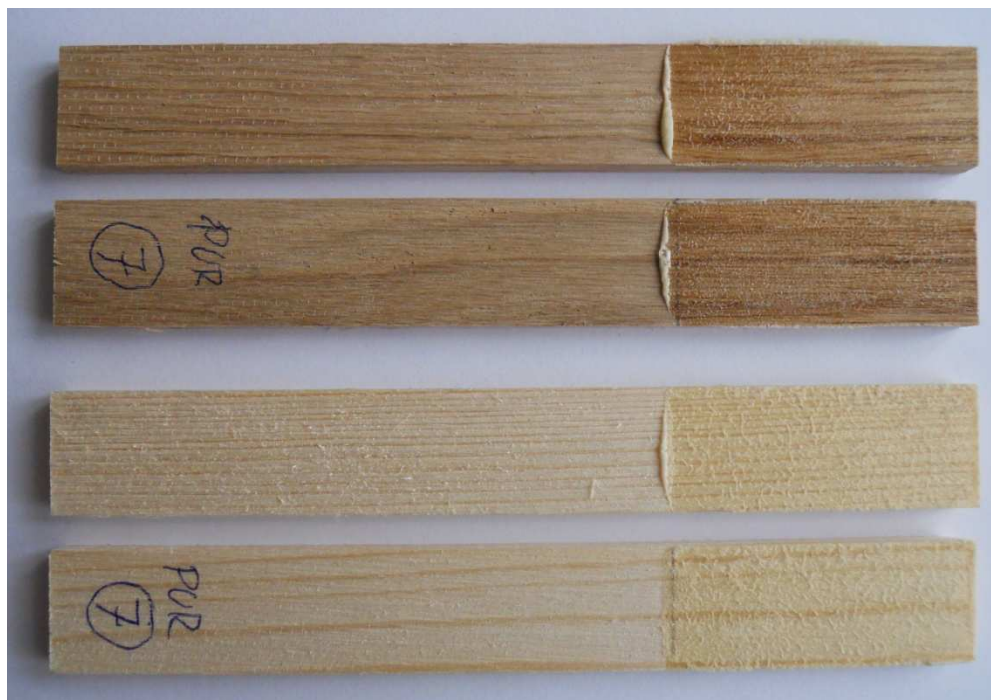
Obr. 25 – Porušení vzorků dubu a smrku, lepených PUR lepidlem a vystaveným smykové zkoušce tahem při teplotě - 20 °C (galerie autora)
