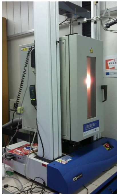
Obr. 16 – Klimatizační komora (galerie autora)
