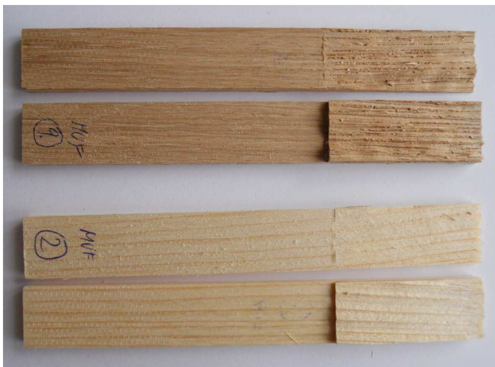
Obr. 21 – Porušení vzorků dubu a smrku, lepených MUF lepidlem a vystaveným smykové zkoušce tahem při teplotě - 20°C (galerie autora)
