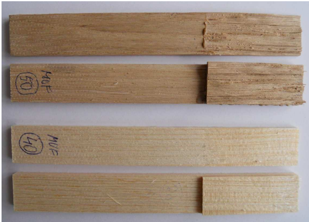
Obr. 19 – Porušení vzorků dubu a smrku, lepených MUF lepidlem a vystaveným smykové zkoušce tahem při teplotě 24 °C (galerie autora)
