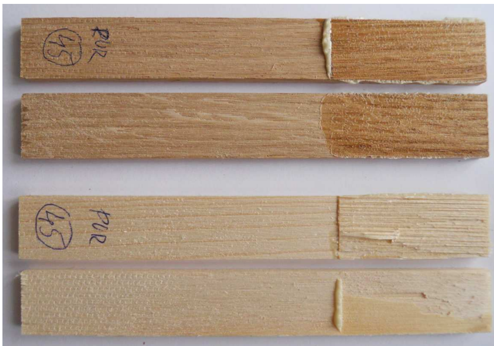
Obr. 23 – Porušení vzorků dubu a smrku, lepených PUR lepidlem a vystaveným smykové zkoušce tahem při teplotě 24 °C (galerie autora)
