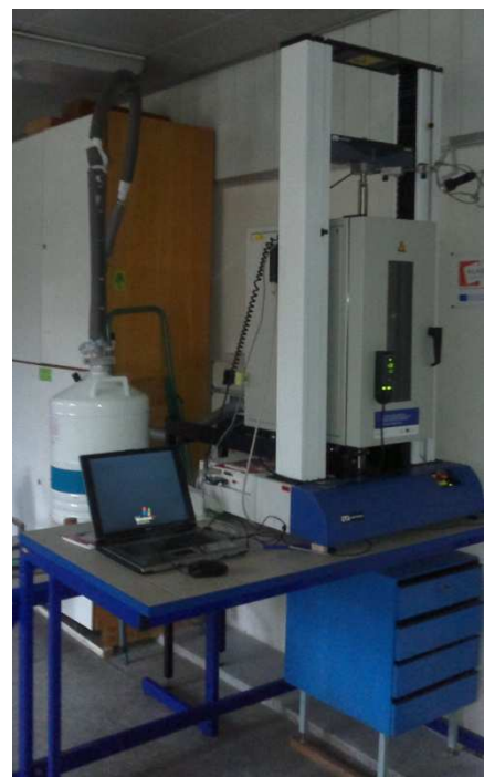
Obr. 14 – Trhací zařízení INSTRON s klimatizační komorou a lahví s kapalným dusíkem (galerie autora)
