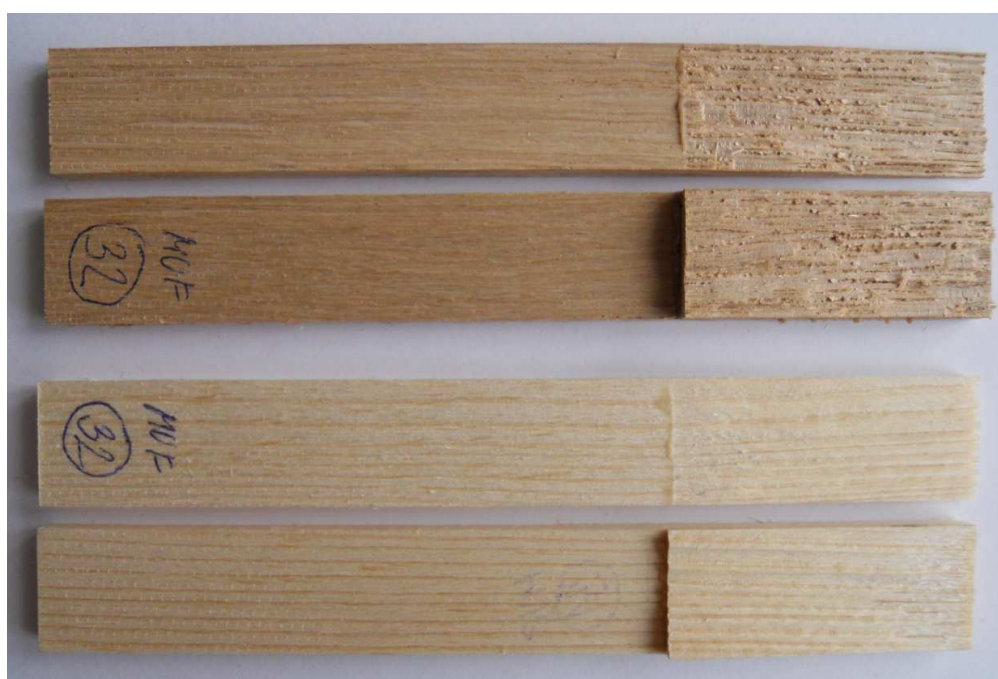
Obr. 22 – Porušení vzorků dubu a smrku, lepených MUF lepidlem a vystaveným smykové zkoušce tahem při teplotě - 30°C (galerie autora)
