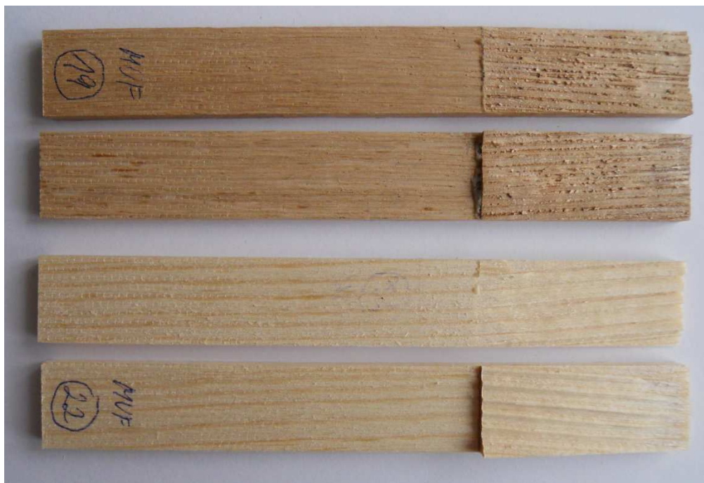
Obr. 20 – Porušení vzorků dubu a smrku, lepených MUF lepidlem a vystaveným smykové zkoušce tahem při teplotě 5 °C (galerie autora)
