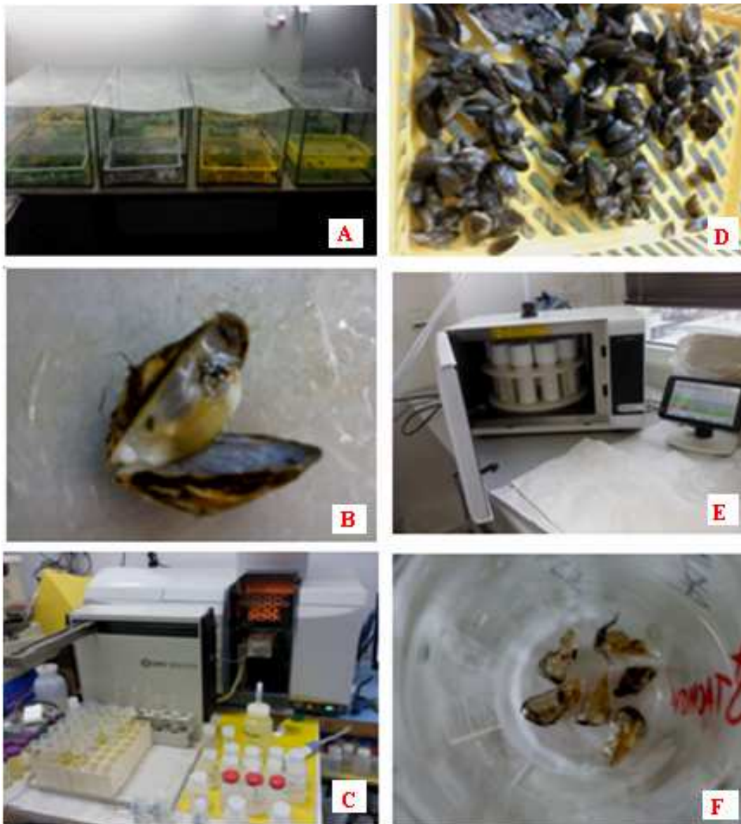
Obrázek 22. Foto, A: živé D.P. v akváriích v době expozice; B: mrtvá D.P.; C: AAS Avanta. D: živé D.P. v drúzách; E: mineralizátor Speedwave 2; F: D.P. bez lastur v benzenu, K.Štachová 2015
