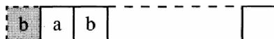
Obrázek 2.14: Reflexní okrajové podmínky [11], kde a je buňka pro kterou se pravidla aplikují a b je stav virtuální buňky.
