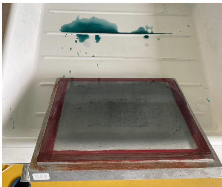
Obrázek 7.1 Čištění starého fotorezistu ze síta
