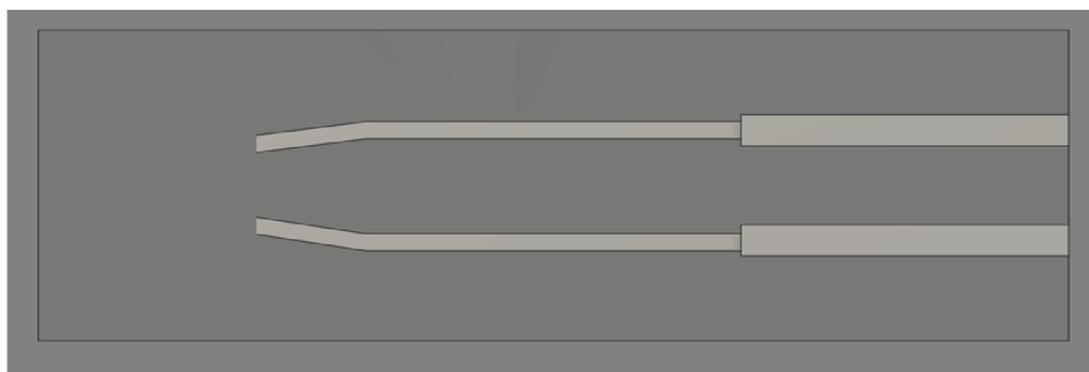
Obrázek 6.4 Vodivá vrstva dvouelektrodového senzor s kruhovými elektrodami
