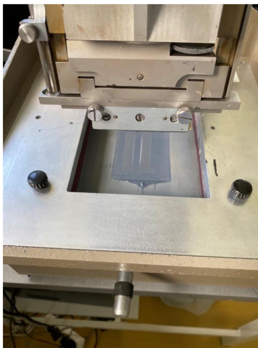
Obrázek 7.8 Způsob nanášení pasty
