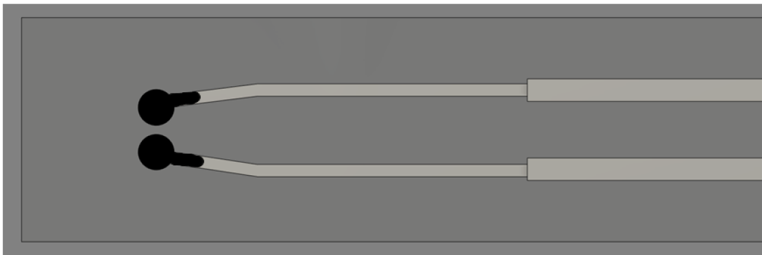
Obrázek 6.5 Funkční vrstva dvouelektrodeového senzoru s kruhovými elektrodami
