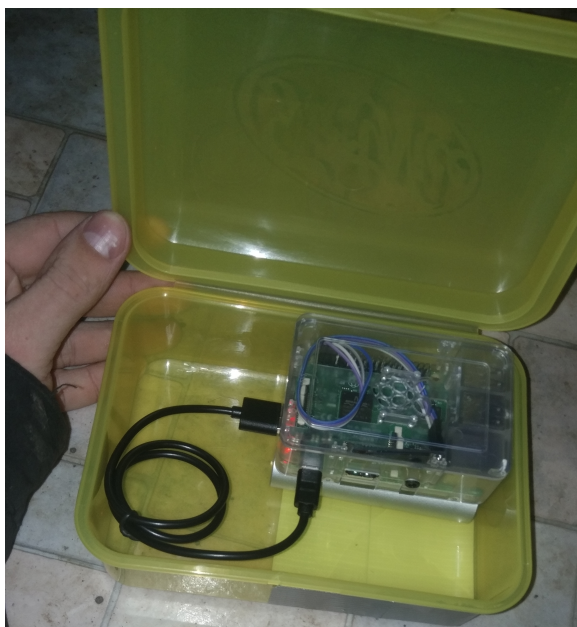
Obrázek 28: Prototyp zařízení pro detekci záchvatů (vlevo) Detail display s přehledem o aktuálním stavu baterie a průběhu měření (vpravo); (autor)
