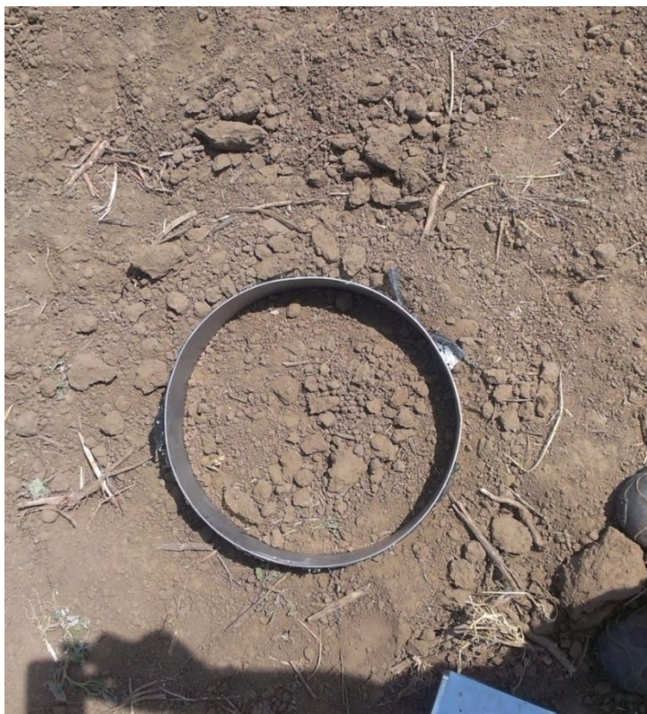
Foto č. 13: Měření 6 – pohled do válce po infiltračním pokusu (je zde vidět, jak zareagovala půda, jak do půdy zapadala/propadala se tyčka na měření topografie)
