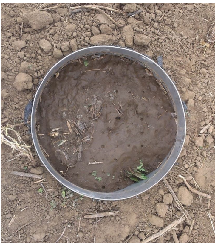
Foto č. 13: Měření 6 – pohled do válce po infiltračním pokusu (je zde vidět, jak zareagovala půda, jak do půdy zapadala/propadala se tyčka na měření topografie)
