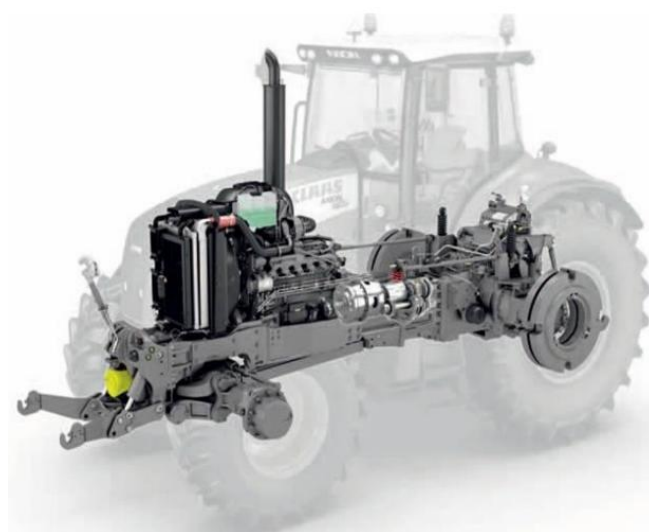
Obr. 25 Polorámová konstrukce traktoru Claas Axion (zdroj: Bakalářská práce Podvozky traktorů vyšších výkonových kategorií)
