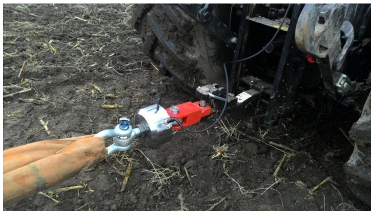
Obr. 41 Tenzometrický snímač tahové síly (zdroj: autor)
