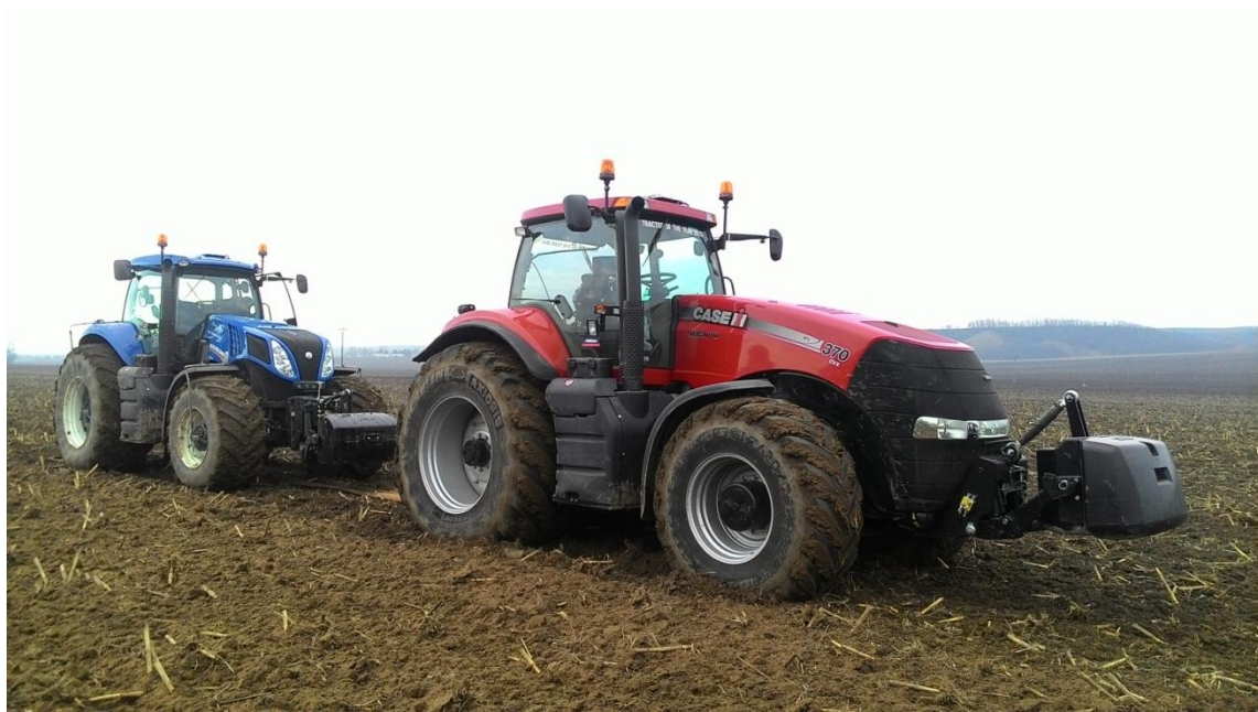
Obr. 38 Měřený traktor Case IH Magnum 370 cvx s brzdícím traktorem New Holland T8.420 Autocommand (zdroj: autor)
