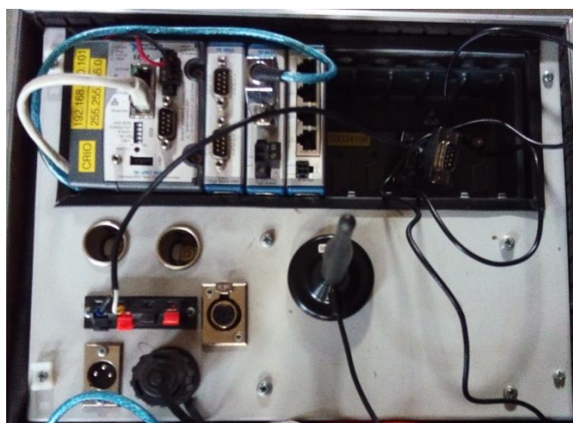
Obr. 40 Měřicí ústředna CompactRio (zdroj: autor)
