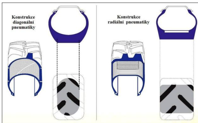
Obr. 29 Konstrukce diagonálních a radiálních pneumatik (zdroj: Diplomová práce Vliv konstrukce podvozků na tahové vlastnosti traktorů)
