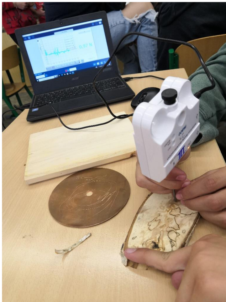
Obrázek 9 - Měření tvrdosti povrchu březového dřeva
