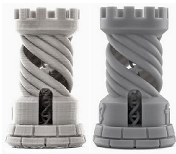
Obr. 6 – Rozdíl povrchu FDM a SLA tiskáren [12]
