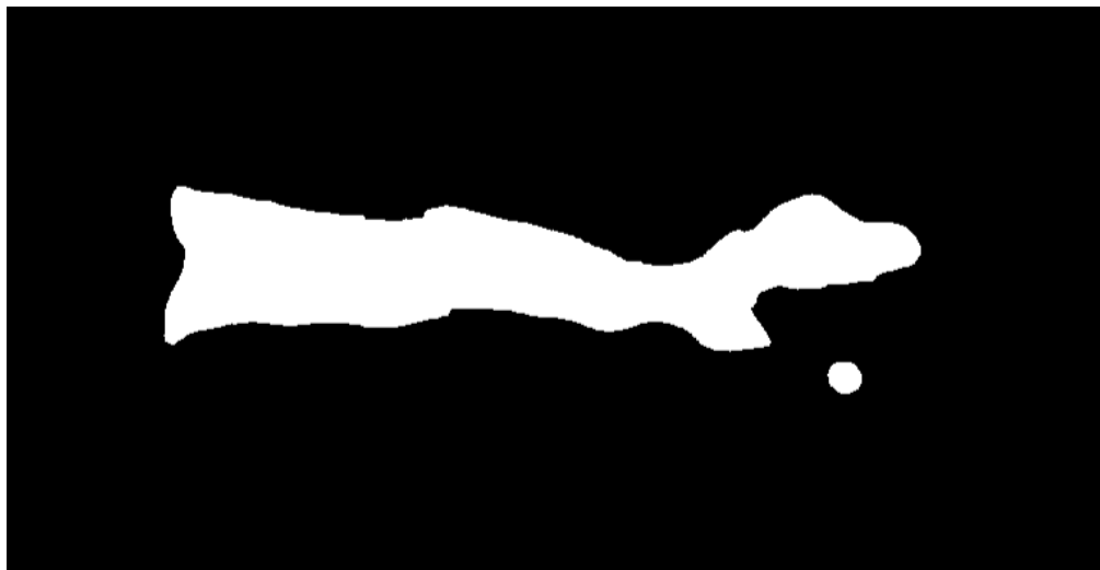
Obr. 5 – Průřez vrstvy pro SLA tisk
