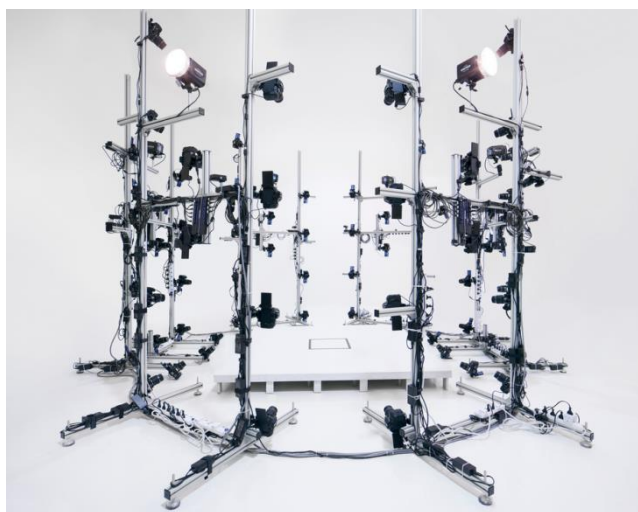
Obr. 14 – Kamerový systém pro skenování osob [35]
