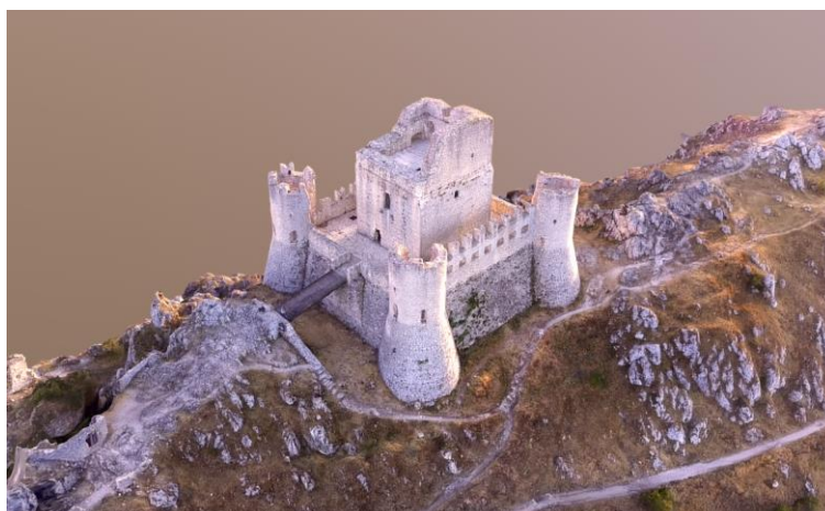
Obr. 13 – 3D sken pomocí dronu [33]
