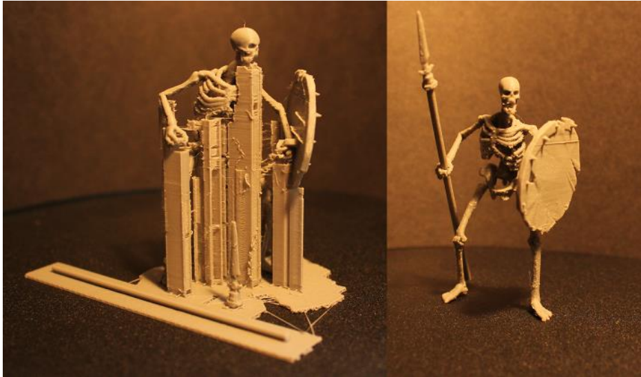
Obr. 17 – Výtisk s podpěrou vlevo, finální model po úpravách vpravo
