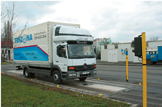
Obr. 6.7 Tenzometrická váha určená pro vážení silničních vozidel
