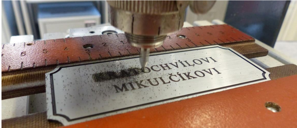
Obr. 6: Ukázka gravírování textu do plechu [18]
