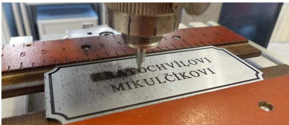
Obr. 6: Ukázka gravírování textu do plechu [18]
