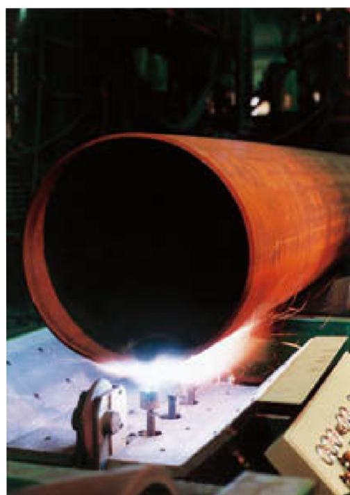
Obr. 20 Rovnání trubky pomocí metody rovnání plamenem [12]
