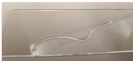
Obrázek 23: Vlákno po absorpci kapaliny
