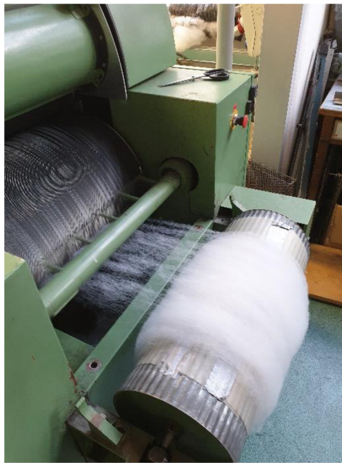
Obrázek 28: Tvorba vlákenné vrstvy na válcovém mykacím stroji
