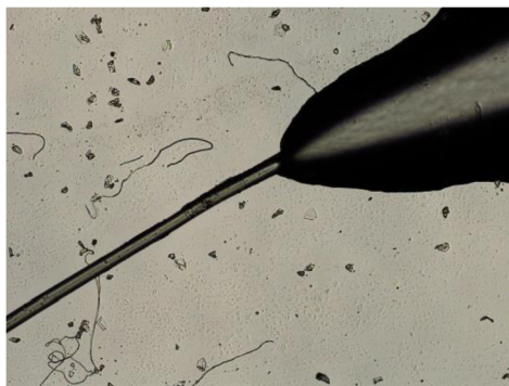
Obrázek 24: Postupné bobtnání superabsorpčního vlákna
