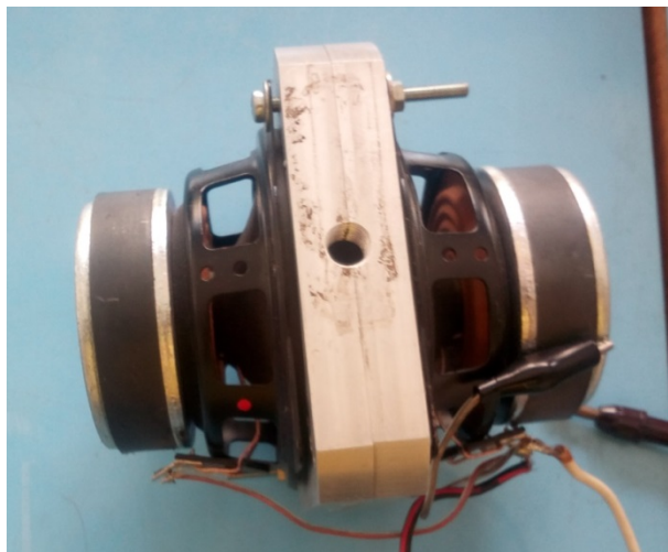
Obr 3.1: Tryska na SJ, je vidět vstupní/výstupní otvor
