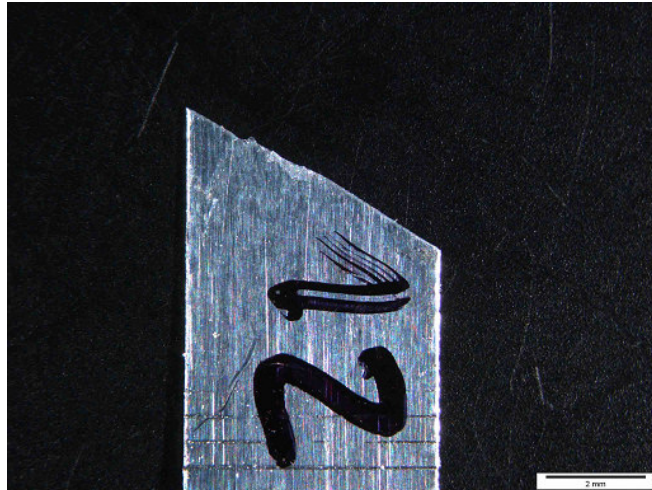
Obr. 49. Makro-snímek zkušební vzorku stříhaných pásků po lomu
