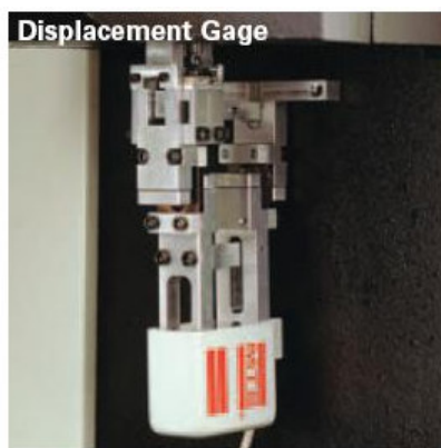
Obr. 45. Snímač přemístění s vysokým rozlišením
