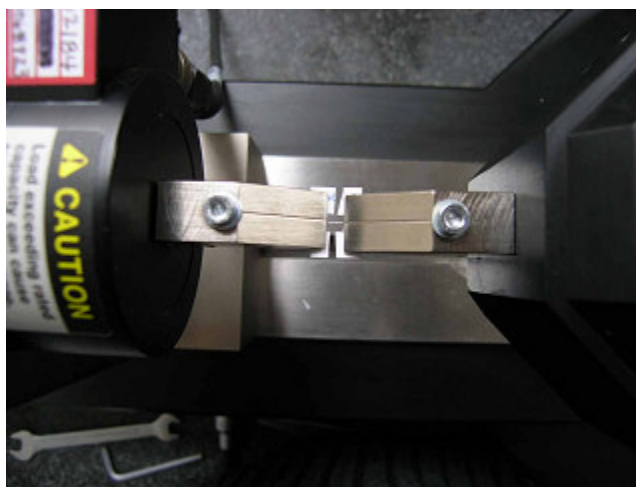
Obr. 53. Zkušební vzorek (Al vlákno 180 \mu\text{m} ) upnutý do čelistí testovacího stroje MTS Tytron 250 s vystříženými částmi papírové podložky
