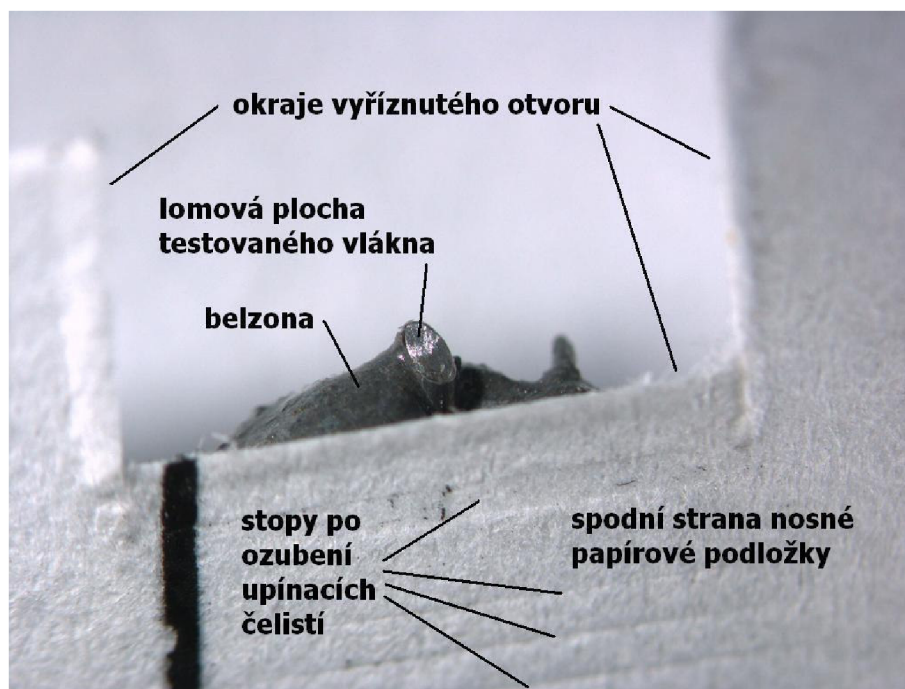
Obr. 92. Al vlákno o průměru 500 \mu\text{m} vzorek 2 po lomu na rozhraní vlákna a Belzony
