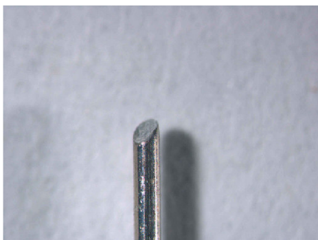
Obr. 60. Vlákno Al o průměru 500 \mu\text{m} vzorek 2 po lomu; lom je pod úhlem přibližně 45°
