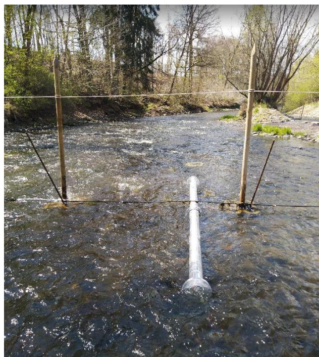
Příloha č. 10: Speciální zařízení při testování počtu skenů antény ve voděodolném pouzdře
