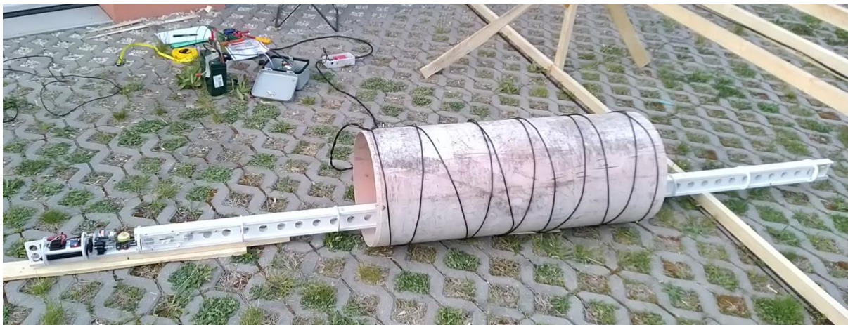
Příloha č. 7: 3D válcový design zig-zag antény (0,4x0,4x1 m) spolu se speciálním testovacím zařízením pro počty zaznamenání tagů
