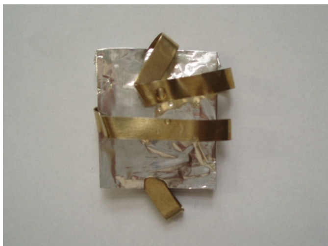
Obr. 10. Segment v rámečku z filtračního papíru jsme z důvodu zabránění infiltrace a zajištění přenosu tepla vložili do alobalového pouzdra. Aby pouzdro neplavalo na hladině, bylo zatíženo měděným plíškem.
