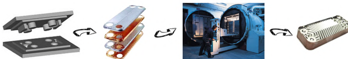
Obr. 21: Proces výroby spájkovaného doskového výmenníka tepla [34]
