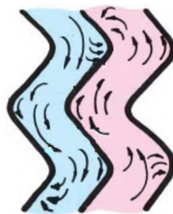
Obr. 9: Turbulentné prúdenie v kanáloch doskového výmenníka [28]
