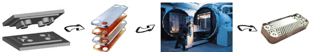
Obr. 21: Proces výroby spájkovaného doskového výmenníka tepla [34]
