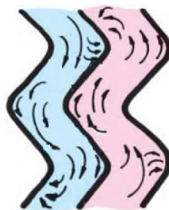
Obr. 9: Turbulentné prúdenie v kanáloch doskového výmenníka [28]
