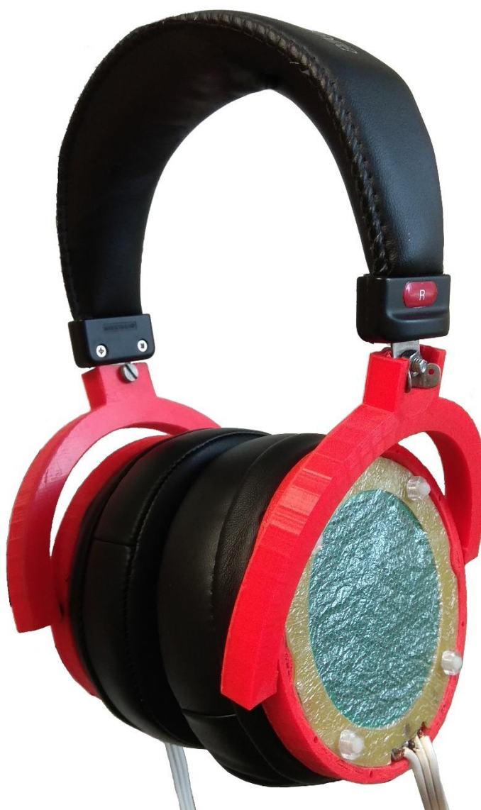
Obrázek 3-5 Prototyp elektrostatických sluchátek bez ochranných mřížek
