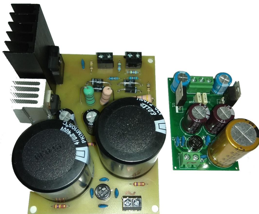
Obrázek 4-10 Prototypy osazených DPS vysokonapěťového zdroje a zdroje \pm 15 \text{ V}
