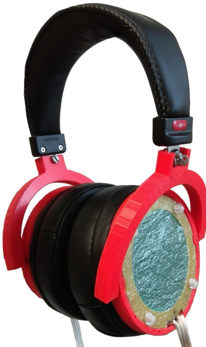
Obrázek 3-5 Prototyp elektrostatických sluchátek bez ochranných mřížek
