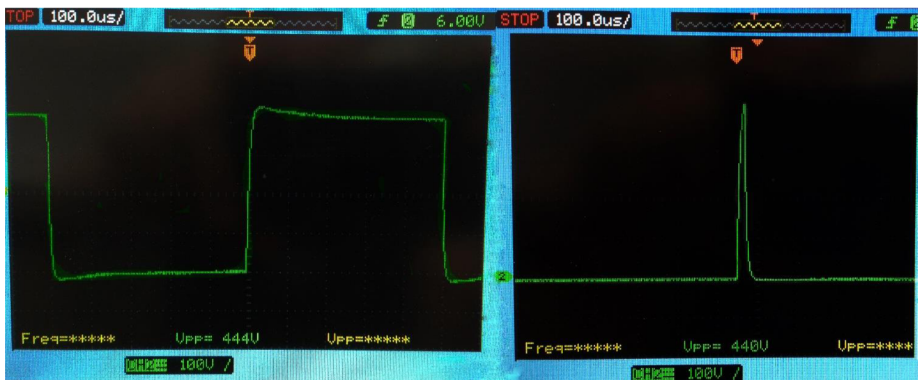
Obrázek 5-2 Odezva na obdélníkový a impulsní signál
