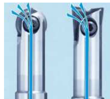
Obr.52 Vnitřní chlazení přes drážky břitových destiček [17]
