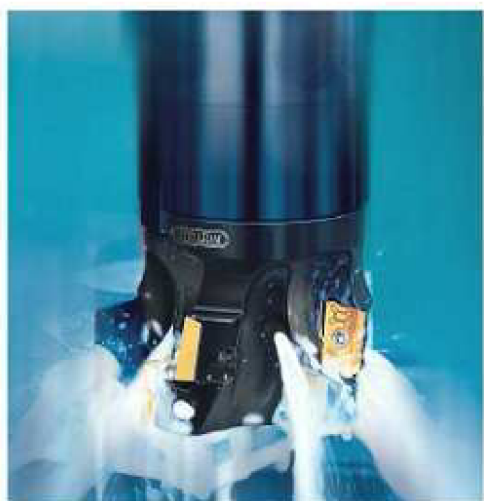
Obr.53 Fréza firmy Stellram s vnitřním chlazením [6]
