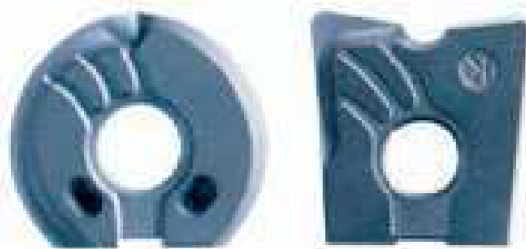
Obr.51 Drážky u VBD pro vnitřní chlazení [17]
