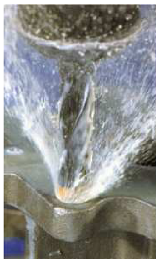
Obr.48, 49 Příklady aplikace vysokotlakého chlazení u nástrojů [16]
