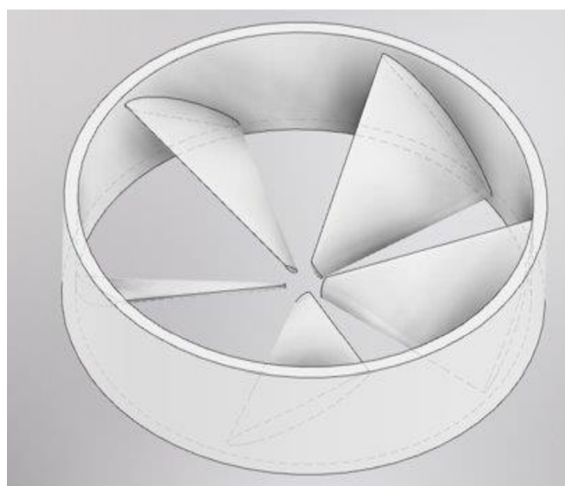
Obr. 5-6 Prvotní koncept lopatek "Rim-Thrusteru" [86]
