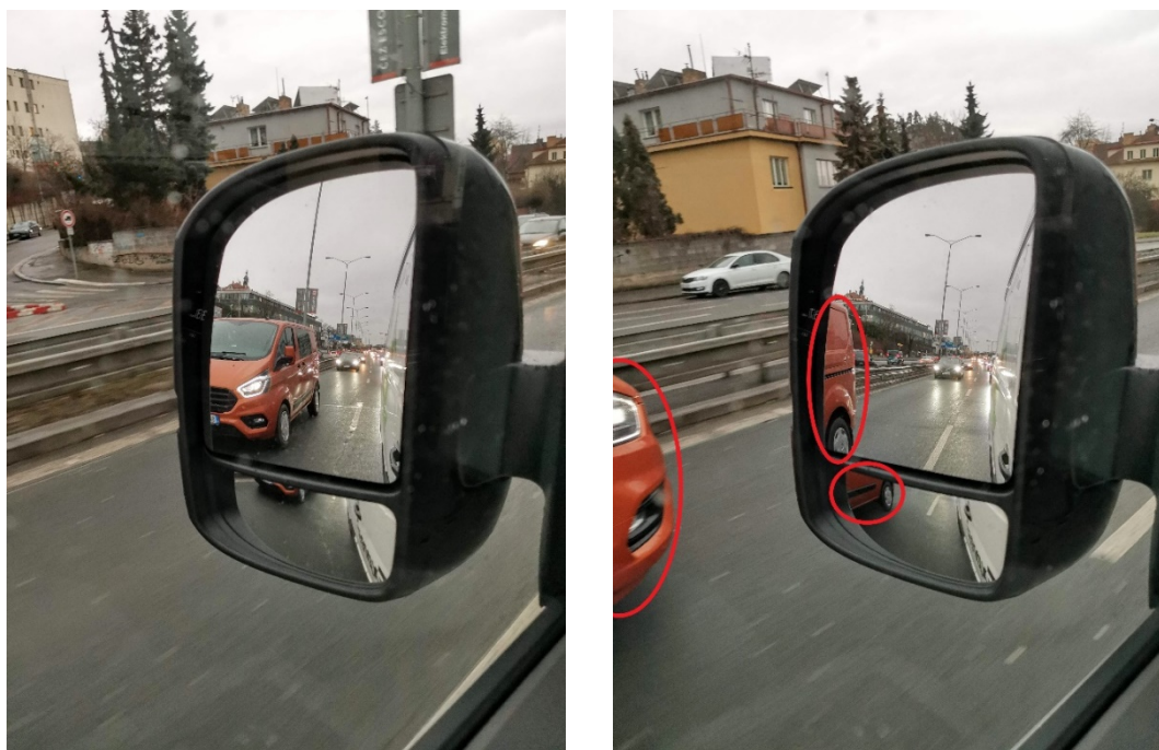
Obr. 26 – Překrytí viděných polí u předjíždějícího vozidla [autor]
