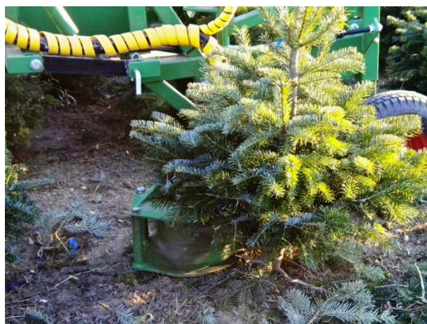
Obr. 9: Frézování spodních přeslenů větví Zdroj: Vlastní fotoarchiv
